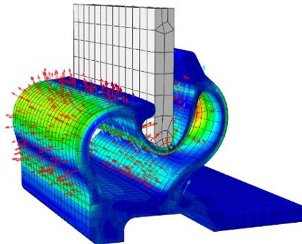
Eindringversuch einer Türdichtung des A380
